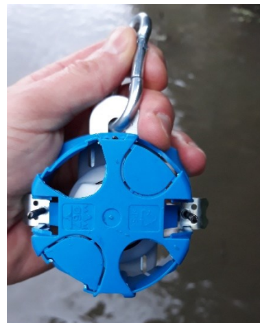
Fig.2 - protection de la sonde
